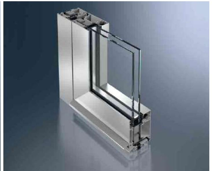
De Schüco-deur ADS 70.HI (High Insulation) combineert uitstekende thermische isolatie met de voordelen van de Schüco ADS-deursystemen. De basisdiepte van 70 mm zorgt voor een hoge stabiliteit. Optionele verbindingen maken het mogelijk om gebruikt te worden als een multi-purpose-deur en geïntegreerd worden in het beveiligings- en beheersysteem van gebouwen. Het tijdloze ontwerp is ook beschikbaar met afgeronde hoeken (SL-versie) en is ideaal om te combineren met de Schüco-gevel- en raamsystemen.
